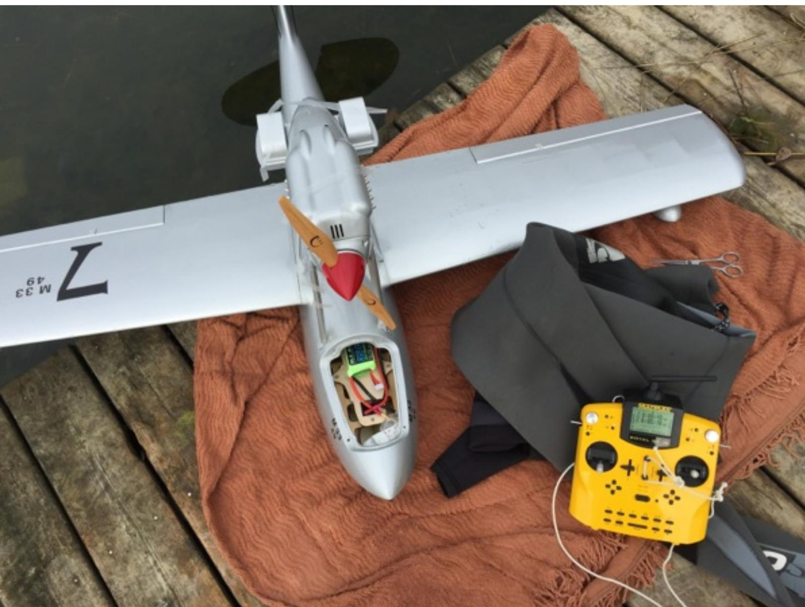
*Dans cette image on a un bon exemple d'analyse de l'environnement et de la fiabilisation qui en découle : notez la présence du scotch qui permettra de renforcer l'étanchéité du capot une fois fermé. L'auteur aura pris soin également de mettre le récepteur dans une poche plastique si d'éventuelles entrées d'eau venaient à se produire. Ceci s'est avéré efficace lors d'une fissure du fond de coque décelée tardivement.*
